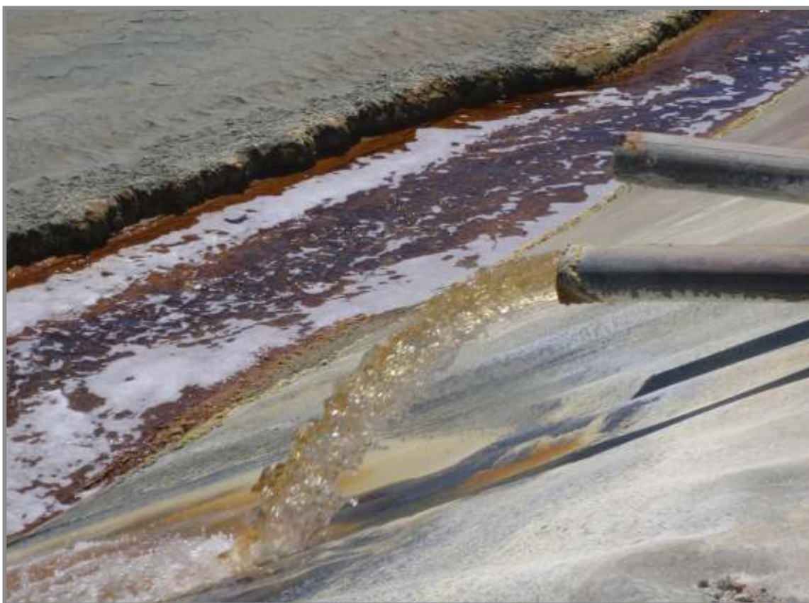
Figura 7b. Una mezcla de agua y estériles de planta con un contenido de sólidos del 35% en masa se descarga hidráulicamente en el estanque de estériles de planta desde la cresta de la presa Cobre en la mina Riotinto de Atalaya Mining en Andalucía, España (ver Fig. 6). Foto tomada por el autor el 21 de junio de 2019.
