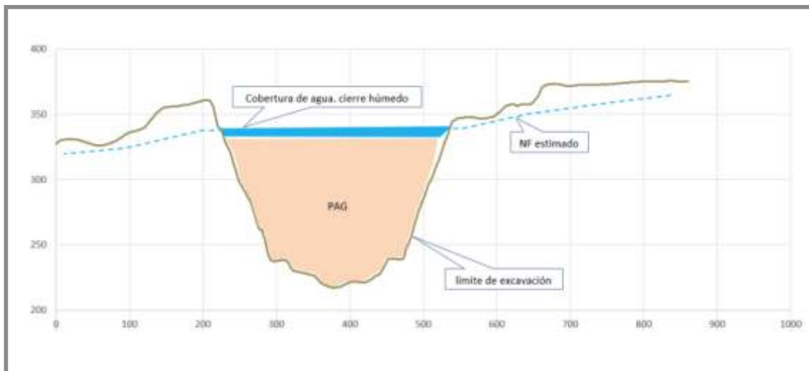
Figura 14b. El Estudio de Impacto Ambiental (EIA) propone una variedad de opciones para prevenir la generación de drenaje ácido de mina a partir de los estériles de mina PAG. Un método implicaría la colocación de los estériles de mina PAG debajo del nivel freático actual en una corta agotada. Sin embargo, el EIA no incluye ningún plan sobre qué hacer si el nivel freático cae, lo que ciertamente es posible ya que la expectativa es que los estériles de mina PAG se almacenen de forma permanente en la corta agotada. Figura de CRS Ingeniería (2023a).
